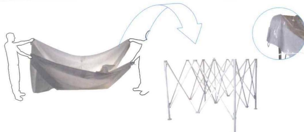
3. Placer la toile sur l'armature en mettant correctement les angles et le centre du mât.
