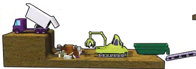
Foso de recepción
