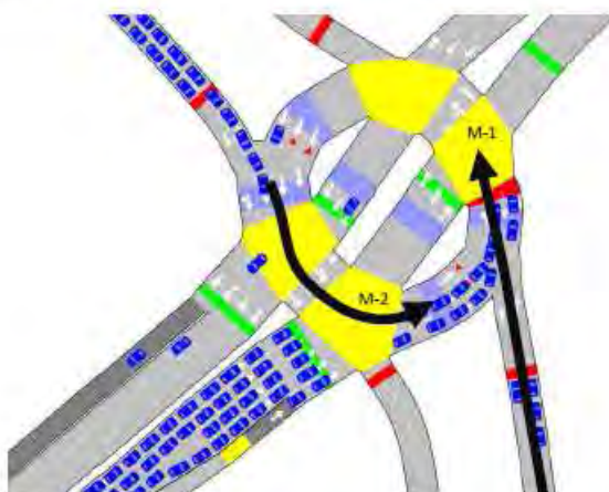
Ilustración 31. Ocupación del ramal de giro a izquierdas Oeste-Bailén de la intersección 4 en el programa AIMSUN 7.0. en HPT.
