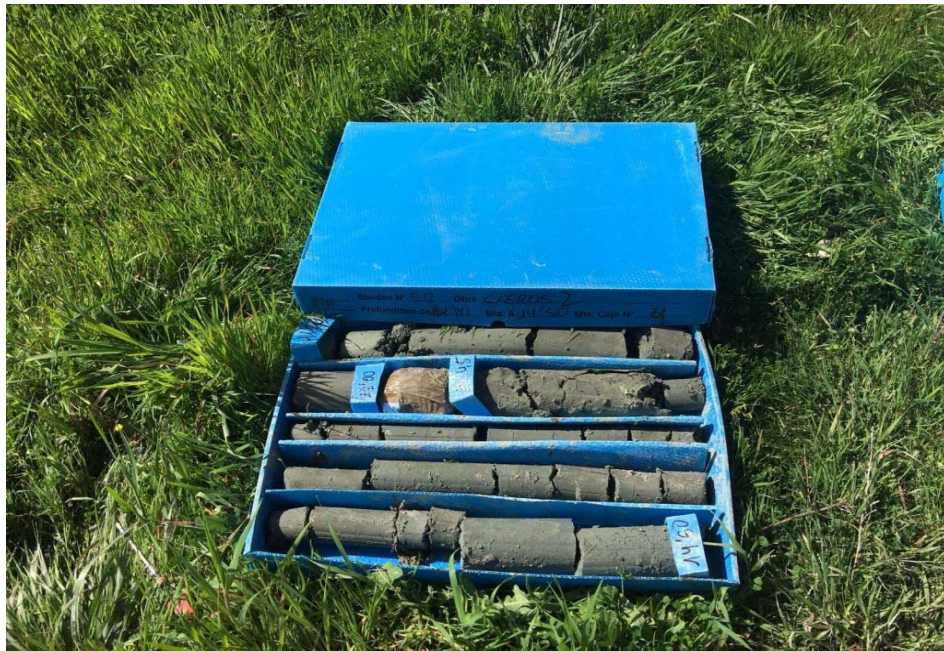
Foto de testigo de sondeo. Sondeo 2, Caja 4.
