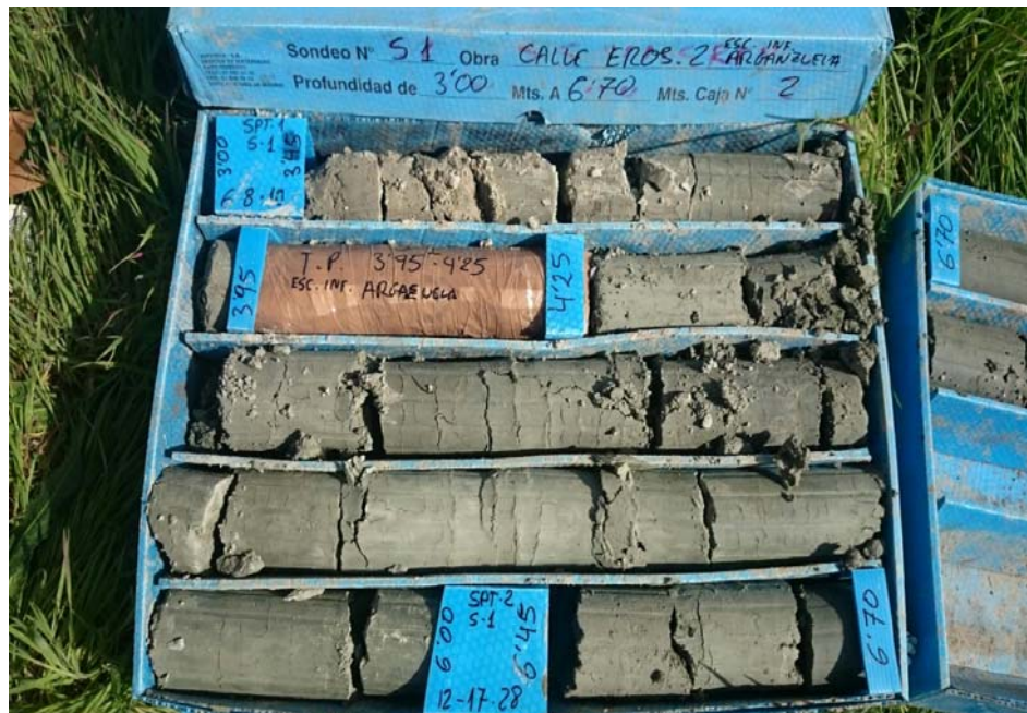
Foto de testigo de sondeo. Sondeo 1, Caja 2.
