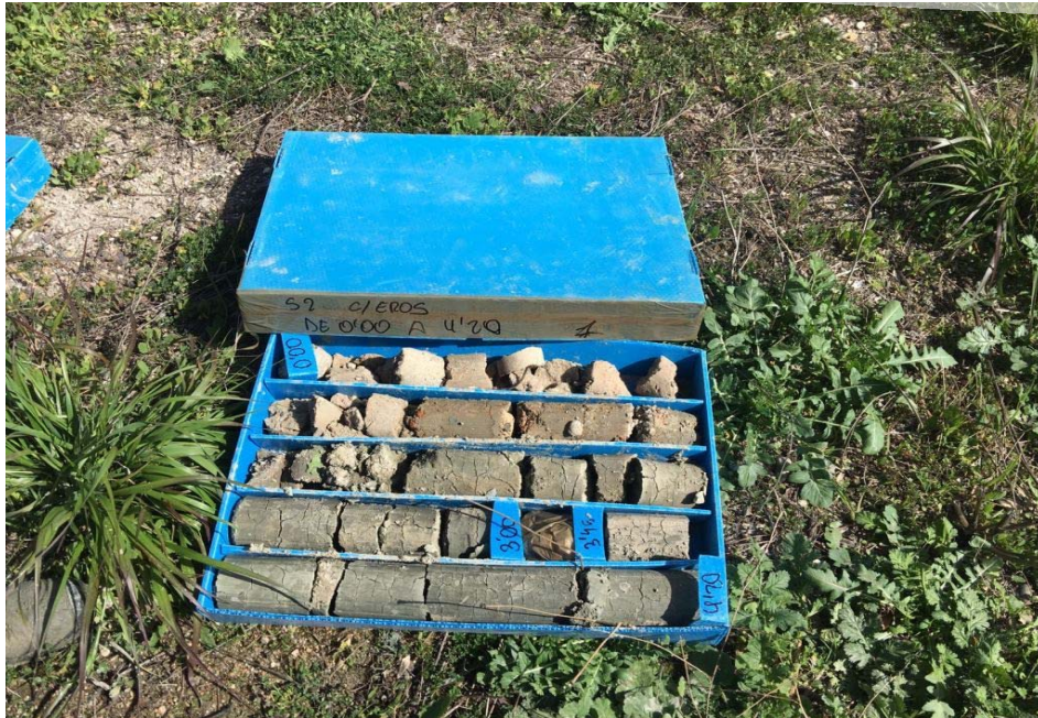
Foto de testigo de sondeo. Sondeo 2, Caja 1.
