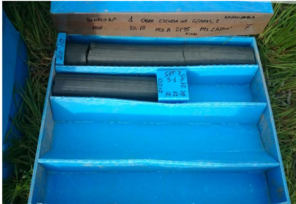
Foto de testigo de sondeo. Sondeo 1, Caja 7.
