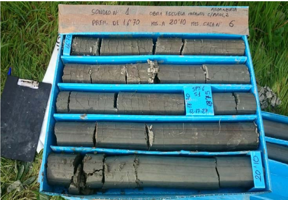
Foto de testigo de sondeo. Sondeo 1, Caja 6.
