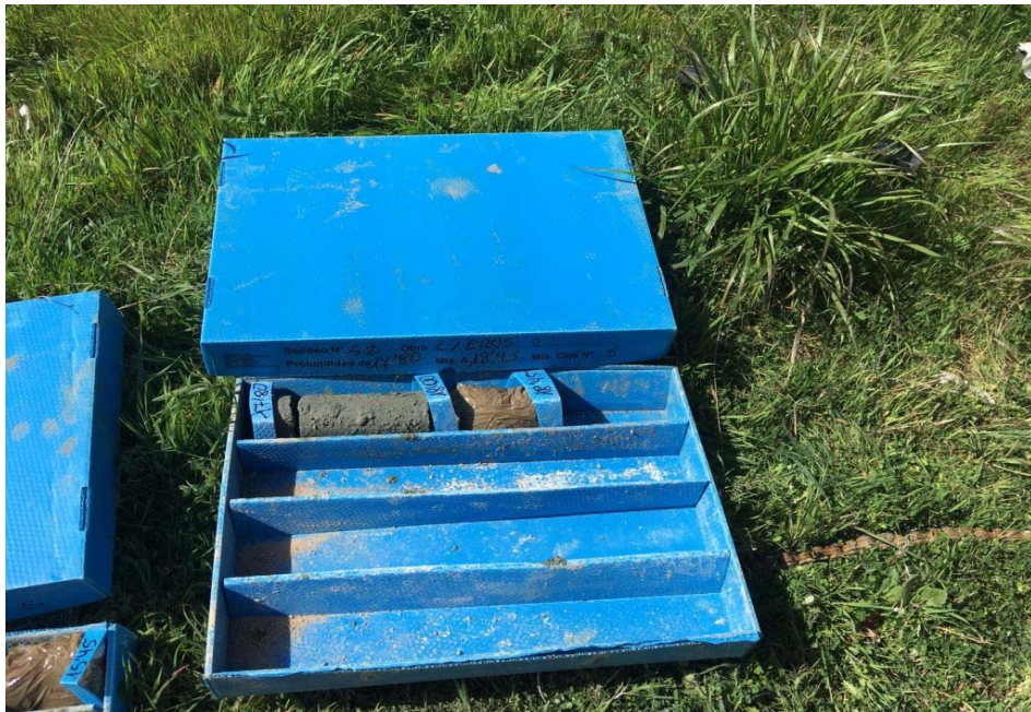
Foto de testigo de sondeo. Sondeo 2, Caja 6.
