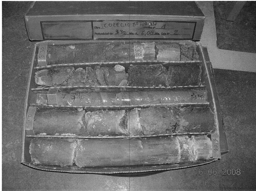
SONDEO 1. CAJA 2. MUESTRA TOMADA ENTRE 3,00 m Y 6,00 m
