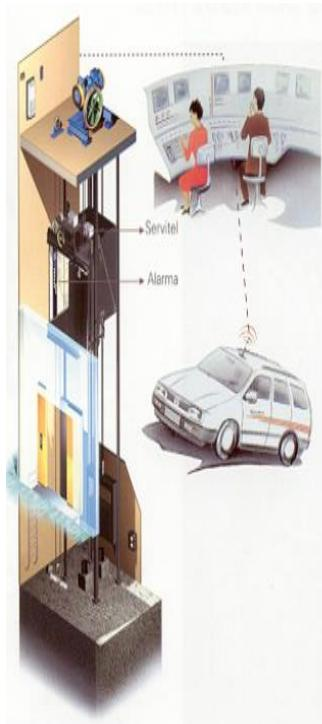
La telealarma es un sistema que permite a los pasajeros hacer llamadas de emergencia desde dentro de la cabina al Centro de Control Permanente de Schindler (24 horas al día, 365 días al año), en el caso de quedar atrapados en su interior, pulsando el botón de alarma situado en la botonera de cabina.
