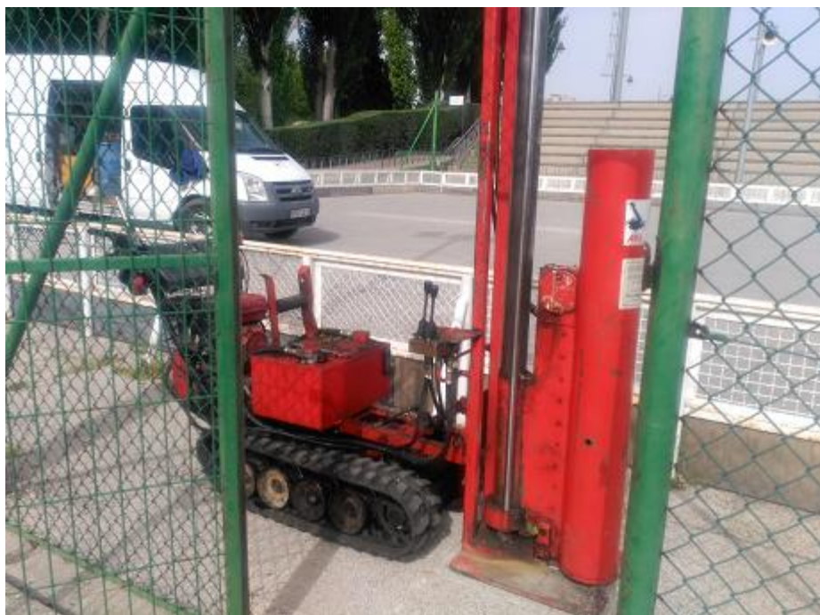
Punto de ensayo de penetración dinámica P2
