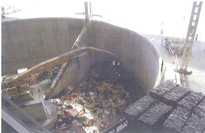
**6.- Incineración de animales muertos y restos de animales.** La capacidad de tratamiento es de 500 kg/hora. Antes de ser incinerados los restos de animales se almacenan temporalmente en una cámara frigorífica a 2°C . Los dispositivos de control instalados en la planta permiten un seguimiento continuo del proceso, tanto en lo que se refiere a las condiciones de combustión, como a la composición de los gases generados y emitidos.
