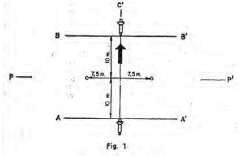
Posiciones para el ensayo de las motocicletas paradas.
